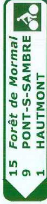
Les panneaux de position sont implantés au niveau d'une branche dans le carrefour même, de manière à ce que l'utilisateur tourne avant le panneau.
